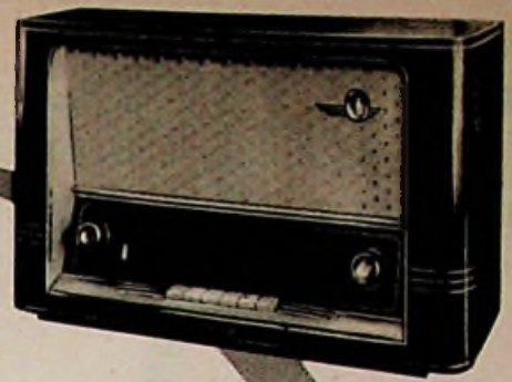
LORENZ-GOLDSUPER W 25 Der komfortable Mittelsuper mit Bandbreitentastung 6/10 Kreise · 7 Röhren · 2 Laut- sprecher · Ferritantenne Baß- und Höhenregelung
