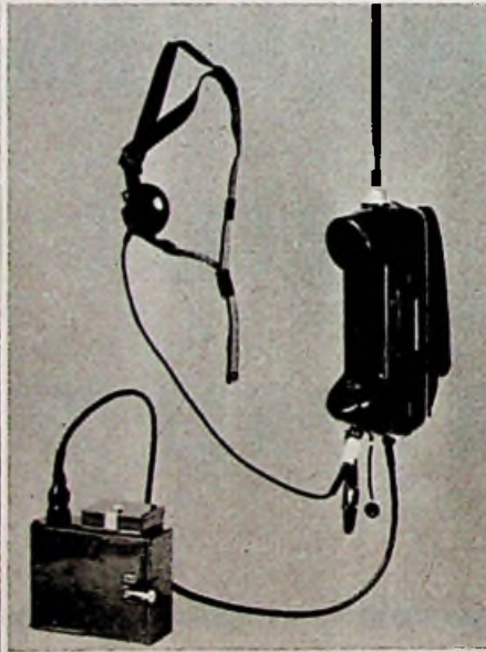
Links: UKW-FM-Funkpredgerät „FuG 250 K“ für Kraftfahrzeuge (Himmelwerk AG.) Rechts: UKW-Handfunkpredgerät „Kl 9“ mit Stromversorgungsteil (C. Lorenz AG.)
